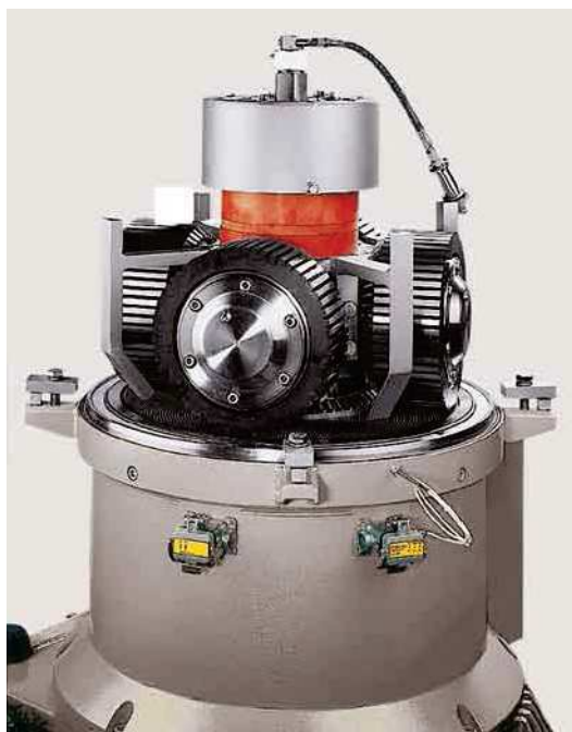
▲ 駆動式バングラインダーローラーは、極端な滑り特性を持つ原料に適しています。
