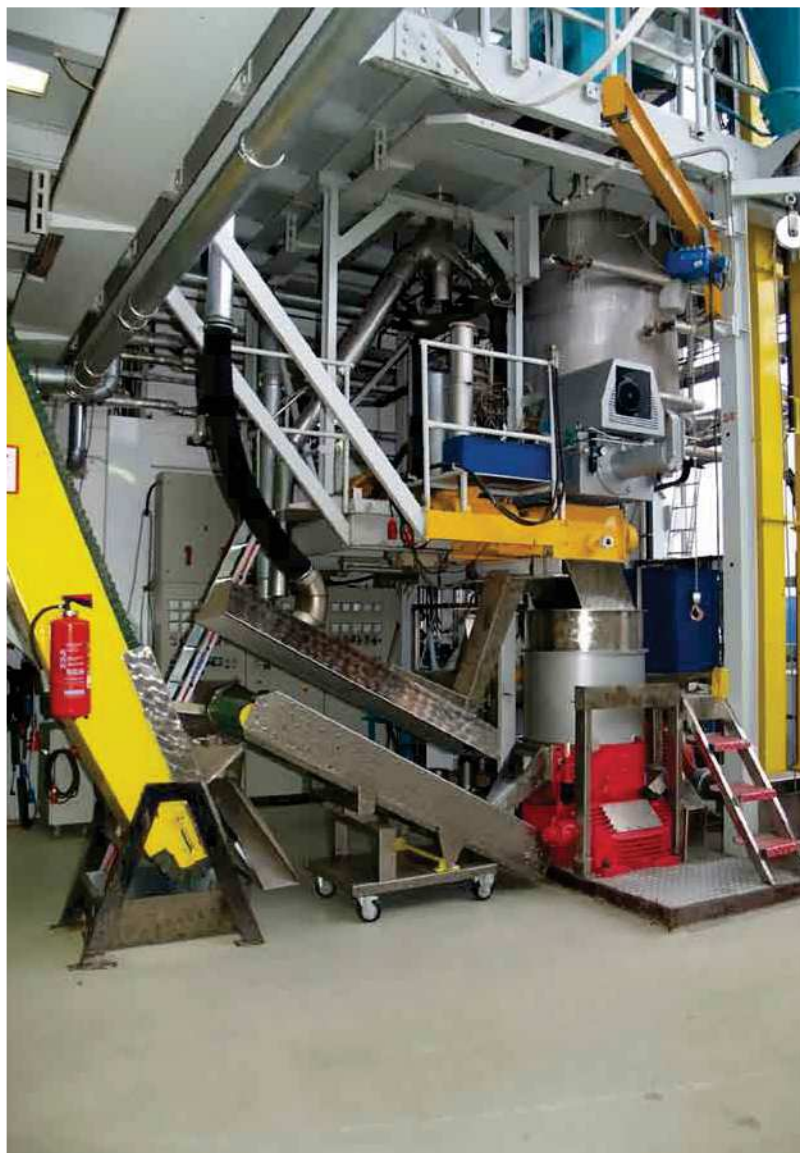
▲ プロポーションングユニット、連続ミキサー、熱水リアクター、annular gap expander、OEE押出機、ペレット成型機、ベルト乾燥機/冷却器、Rotospray、破砕機を備えたKAHLパイロットプラント
