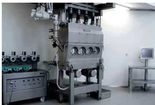
▲ プレーメン近郊ガンダーケゼーにある、コーヒー加工、流動床凝集およびローラー製粉用NEUHAUS NEOTECパイロットプラント
